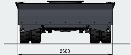
**2-point stabilizers and support blade | 2-Punkt-Abstützung und Stützschild | 2 stabilisateurs et lame d'appui**
